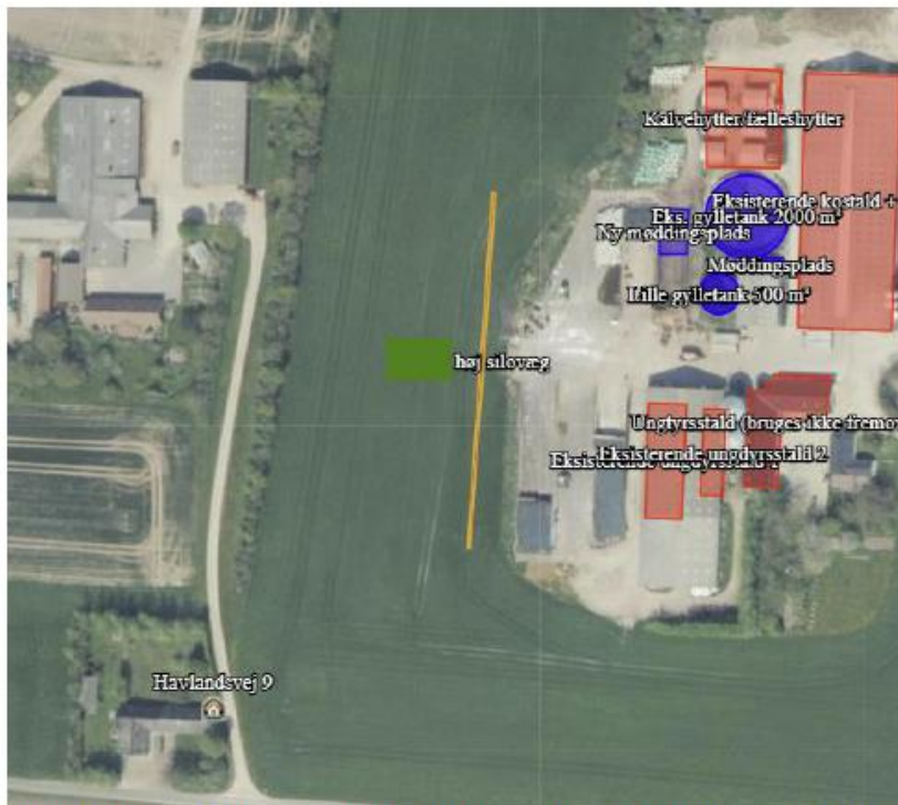
Figur 1, Betonvæg places i området, 3 m høj, 70 m lang. Skitseret med gul linje. Kalvehytter fælles hytter, Eks. Gylletank 2000 m 3 , Lille gylletank 500 m 3 , er ikke medtaget i støjmålinger/beregninger.
